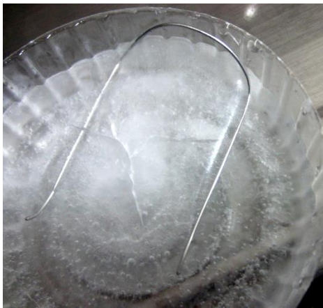
図 1 0.7 mm ステンレス線で作製した、アメンボの足を模したソリ型の金具を水に浮かべ、凍結した写真。指で触るとすぐに溶け始めるので最初が勝負。くぼみの形についての予備知識があると理解が早い。
