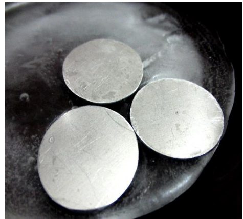
図 2 浮かせて凍結した直径約 25 mm アルミ円板。厚さは左奥から時計回りに、順に 0.5 mm, 1.0 mm, 2.0 mm であり、写真では分かり難いところもあるが、その順に深く沈み、触れば段差がはっきり分かる。
