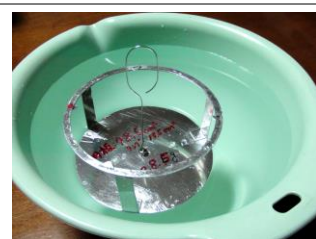
図 9 アルミ板で製作した一体化モデル。下の円板で浮いている。
