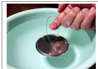
図5 リングを乗せた円板が浮き、フックから指が離れたところ
