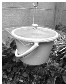
図9 10 lの水を入れたバケツを3 mm 塩ビシートで吊る。
