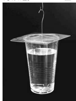
図 3 底に 12 mm の穴を開けたコップを 1.5 mm 塩ビシートで吊り上げた“等価逆さコップ”。
