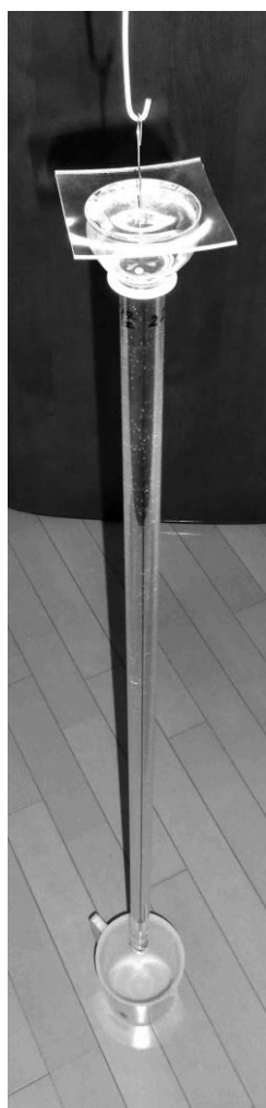
図8 長さ1 mの“等価逆さコップ”。下端は13 mmの穴。
