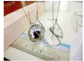
図2 球を固定するフックの構造。ステンレス線製の球の着脱が可能。
