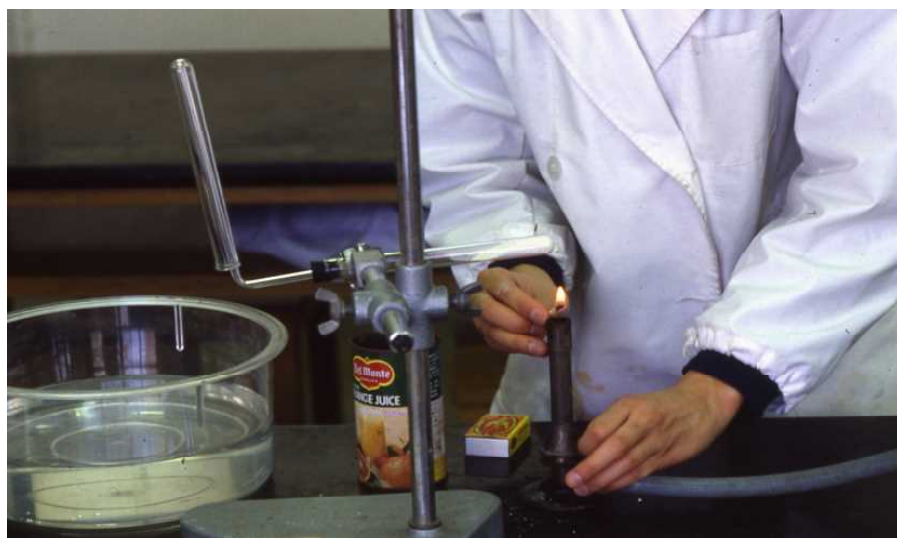
図1 アンモニアの発生実験中、ガスバーナーに点火しているところ。 マッチを持った手の小指が、ガスバーナーの筒に触れて、マッチの炎が筒の上に正確にくるように誘導している。 左手は、ガスバーナーのガス調節ねじを廻している。
