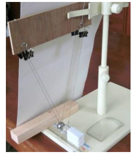
図1 衝突させる振子装置。支点から球の中心までの鉛直距離は22.0 cm。
