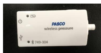
図 2 ワイヤレス圧力センサ (定価 23,000 円(税別)) Bluetooth を使用してタブレ ット端末に接続)
